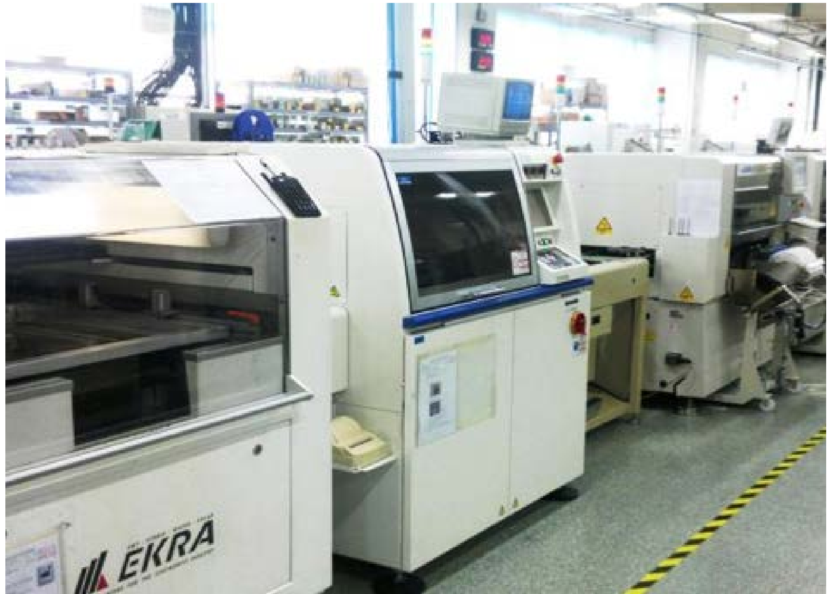
▲ 致茂電子打造綠色製程，已完成無鉛電路板組裝製程 (Printed Circuit Board Assembly, PCBA) 建置。
