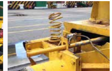
馬達脫落、電源線拉扯損壞、大車右側防撞限位開關動作桿損壞、車防撞限位開關及動作桿損壞
