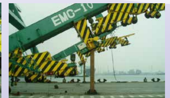
大車底座中點位置製作大型支撐柱，以防止車機再次傾倒
