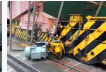
馬達脫落、電源線拉扯損壞、大車右側防撞限位開關動作桿損壞、車防撞限位開關及動作桿損壞
