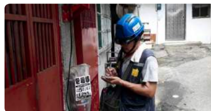
鄰房傾度盤定期觀測
