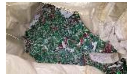
● 新竹廠 - IC 板處理完成 (破碎後)
