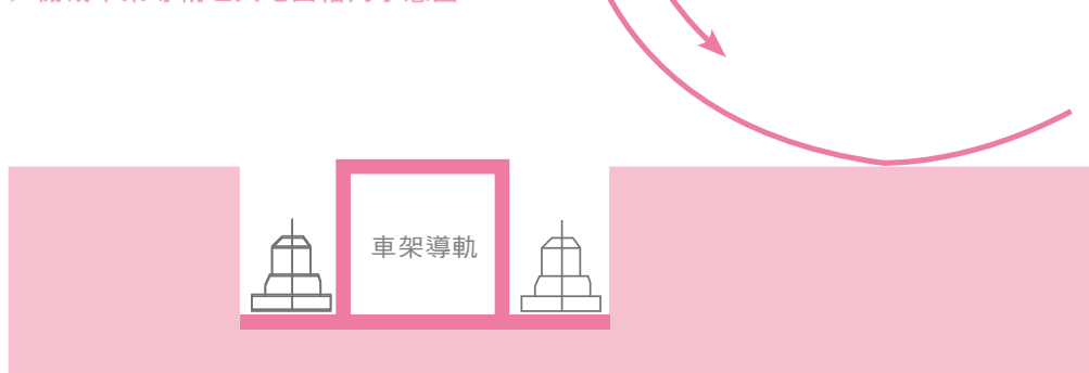
▶ 機械車架導軌埋入地面槽內示意圖
