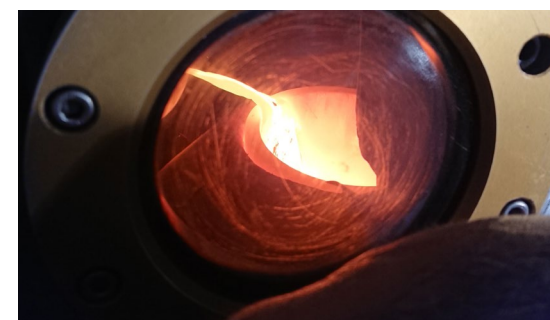
▲光洋應材透過獨特的火法熔煉，將銅管重新純化成高純銅原料
