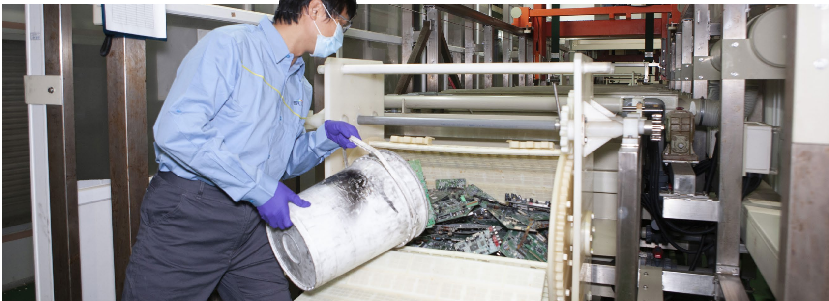
▼光洋應材回收電子廢棄物，並利用綠色製程技術，製作出電子工業等級的材料
